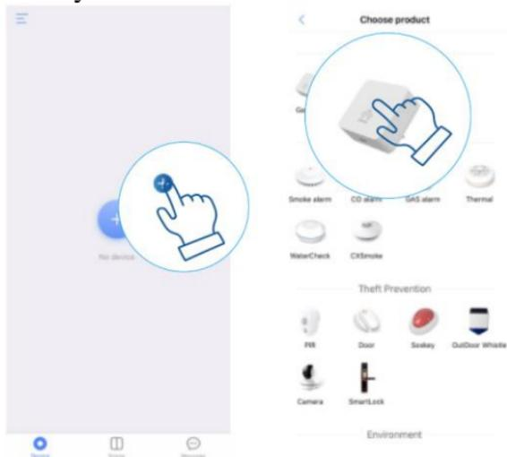
Appuyez sur la touche du Gateway durant 5 secondes jusqu'au clignotement de la LED en bleu. Appuyez ensuite sur «suivant», entrez le mot de passe du réseau et sélectionnez «se connecter». Vous recevrez une information lorsque la connexion sera effectuée.
